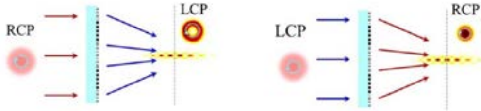
图 1. 超构透镜调制右、左旋圆偏振光示意图
