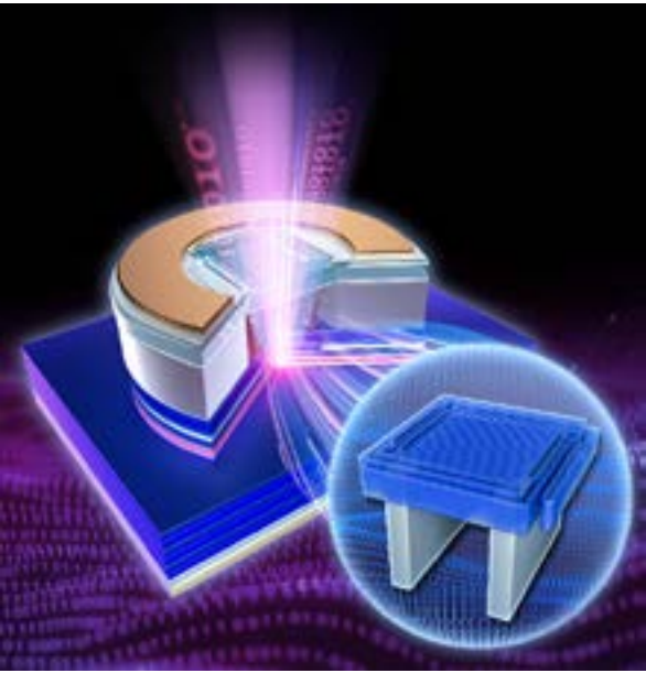
图 1 HCG-VCSEL 的结构示意图
